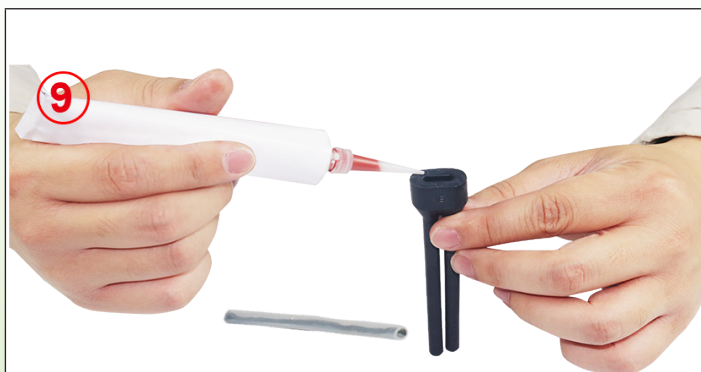
9 : Verser de la résine silicone RTV dans l'orifice principal du manchon silicone à deux orifices.
